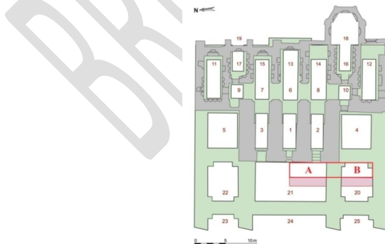
Fig. 7 : Saint-Médard de Soissons. En vert, les fondations et, en gris, les structures de la crypte en élévation. En A et B, emplacement des fouilles proposées en 2020, dans la travée du chœur jouxtant les caveaux occidentaux de la crypte.
